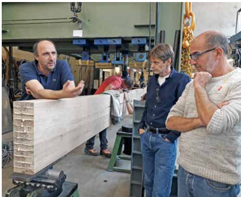
Test meccanici dei lamellari di castagno alla Haute Ecole d'Ingenierie a Yverdon
